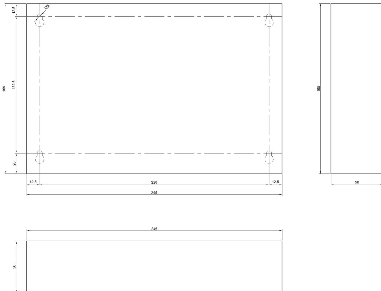
Рисунок А3 – Габаритные и установочные размеры прибора
