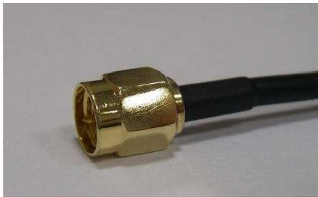
Рисунок 2 – Внешний вид разъема SMA
